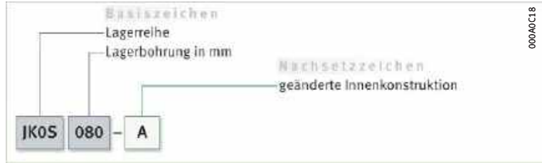
16 Integral-Kegelrollenlager: Aufbau des Kurzzeichens
