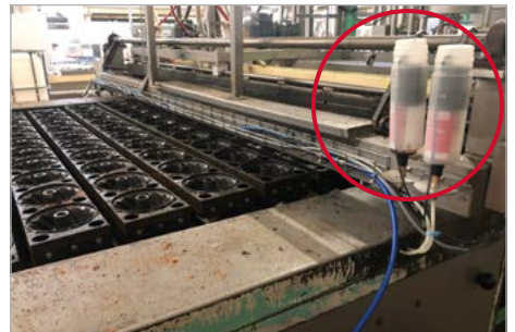
Schmierung einer Ofenkette in einer Backstraße
