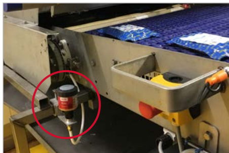
Schmierung eines Flanschlers an einem Förderband mittels entfernter Montage
