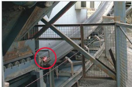
Stehlagerschmierung einer Bandwaage
