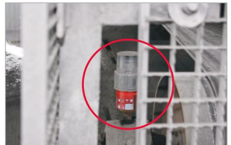
Stehlagerschmierung einer Umlenktrummel
