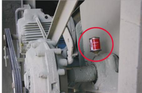
Stehlagerschmierung der Antriebstrommel
