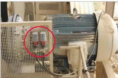
Indirekte Schmierung eines Elektromotors
