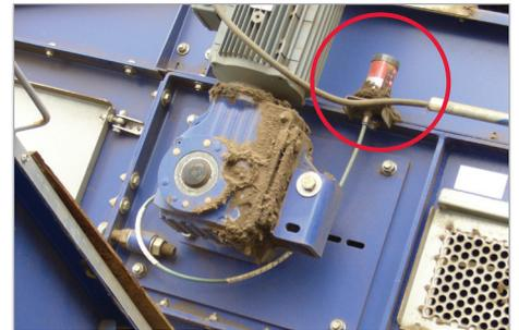
Flanschlagerschmierung einer Förderbandanlage
