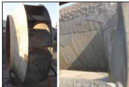
Build-up on fan blades.
