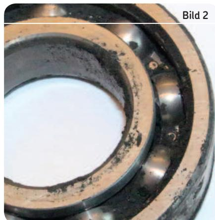
*Der Verlust der radialen Lagerluft führt zu einem festgefressenen Lager*
