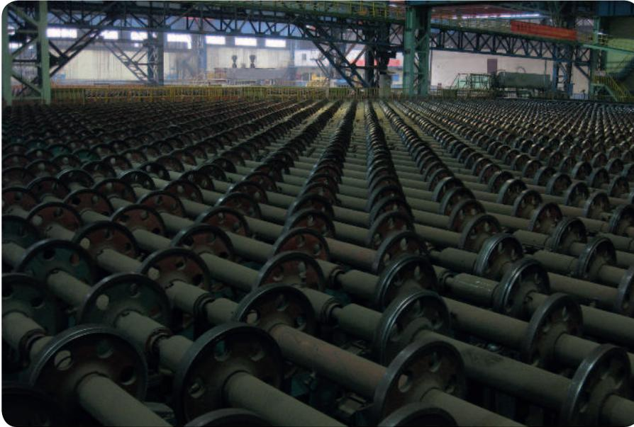
*Ein großes Kühlbett für Stahlplatten. Jedes Rad wird durch vier Hochtemperaturlager gestützt.*
