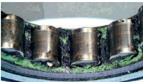
Verschmutzter Schmierstoff durch Funkenerosion
