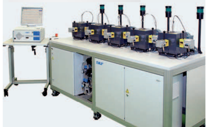
SKF ROF+ Fettprüfmaschine
