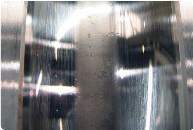
Innenring eines Rillenkugellagers Eindrückungen durch Überrollung metallischer Partikel – unwirksame Dichtungsanordnung
