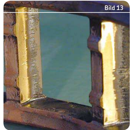
Reibverschleiß an den Käfigstegen eines Zylinderrollenlagers
