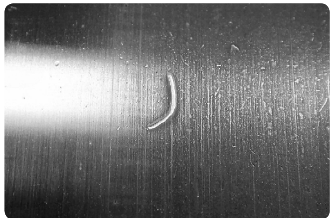
Außenring eines Pendelrollenlagers Überrollter Span führt zu Schälung
