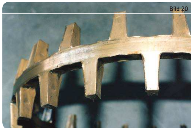
Käfig: starker Taschenverschleiß
