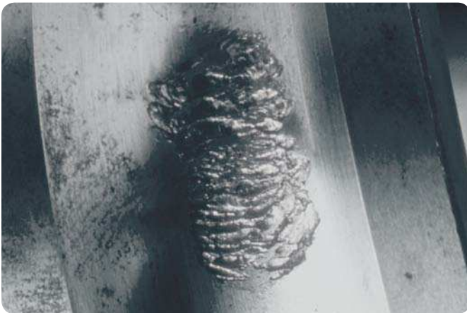
Innenring eines Rillenkugellagers Materialermüdung
