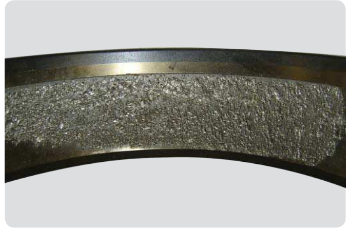
Außenring eines Zylinderrollenlagers Unzureichender Schmierfilm, leichte Schiefstellung, fortgeschrittene Schälung
