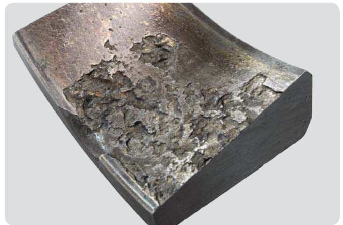
Außenring eines Kegelrollenlagers Oberflächenzerrüttung und fortgeschrittene Schälung infolge eines unzureichenden Schmierfilms
