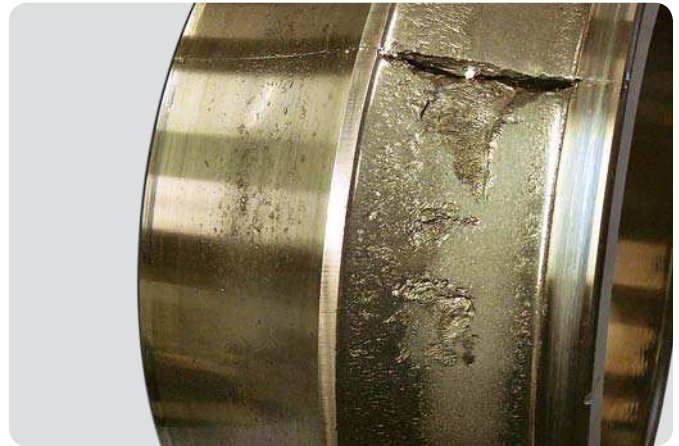
Innenring eines Pendelrollenlagers Starke Schälung – Ermüdungsbruch als Folgeschaden
