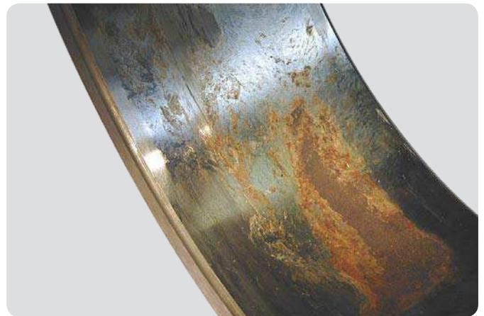
Innenring eines Zylinderrollenlagers Falsche Wellenpassung, ungleichmäßige Unterstützung
