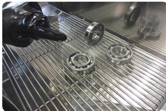
Sauberkeitsprüfung (Verunreinigungsanalyse) – Spülung
