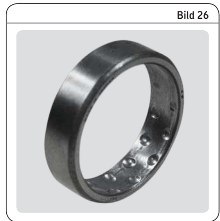
Ausgeprägte Stillstandsmarken an der Laufbahn des Außenrings eines Pendelkugellagers
