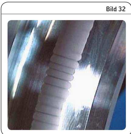
Bildung eines Waschbrettmusters aufgrund kriechstrombedingter Erosion
