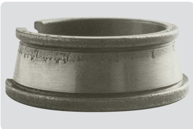
Innenring eines Kegelrollenlagers Einseitige Laufbahnschälung aufgrund von Schiefstellung und dadurch verursachter Randbelastung, was zu höherer Beanspruchung und Ausfall führt
