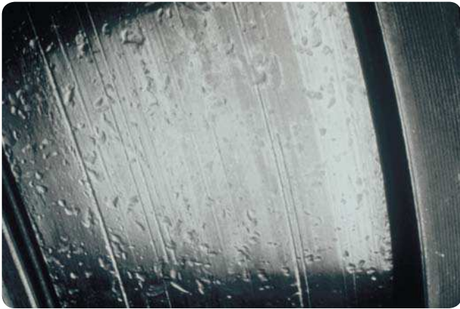
Innenring eines Kegelrollenlagers Eindrückungen großer metallischer Partikel, die aufgrund einer unwirksamen Dichtungsanordnung in das Lager eingedrungen sind
