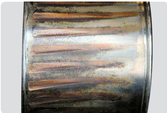
Innenring eines CARB Toroidalrollenlagers Schwingungseinwirkung bei Stillstand mit kleinen oszillierenden Bewegungen, Stillstandsmarken im Rollenabstand
