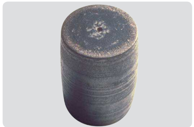
Kugellager – Rolle In das Lager eingedrungene große Wassermengen führten zur Korrosion der Rolle
