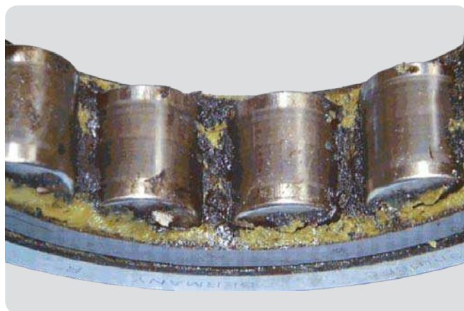
Außenring eines Zylinderrollenlagers mit Käfig, Rollen und Schmierfett Verbranntes Schmierfett (schwarz) an Käfigstegen infolge von Kriechströmen
