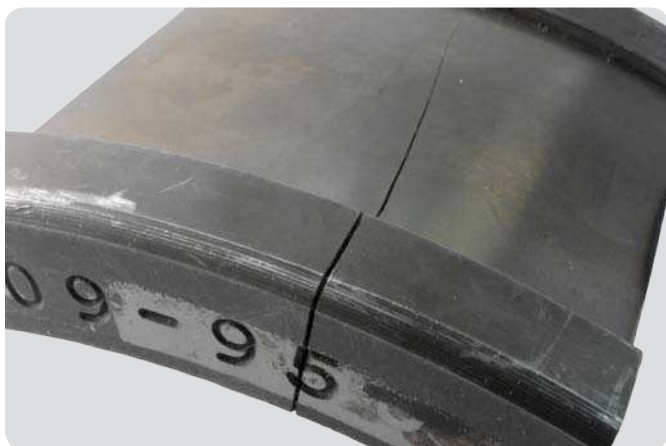
Innenring eines Kegelrollenlagers Das Lager wurde auf einer überdimensionierten Welle angebracht
