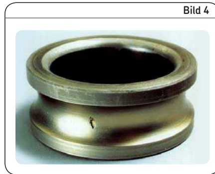
Beginnende Ermüdungsschälung aus der Tiefe am Innenring eines Rillenkugellagers
