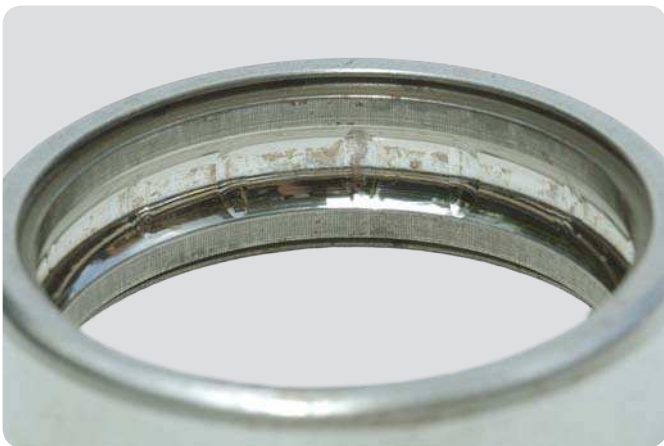
Außenring eines Rillenkugellagers Plastische Verformung im Kugelabstand durch Krafteinwirkung auf den falschen Ring bei der Montage
