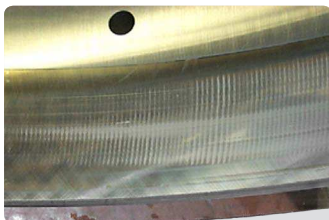
Außenring eines Pendelrollenlagers Kriechstromschädigung
