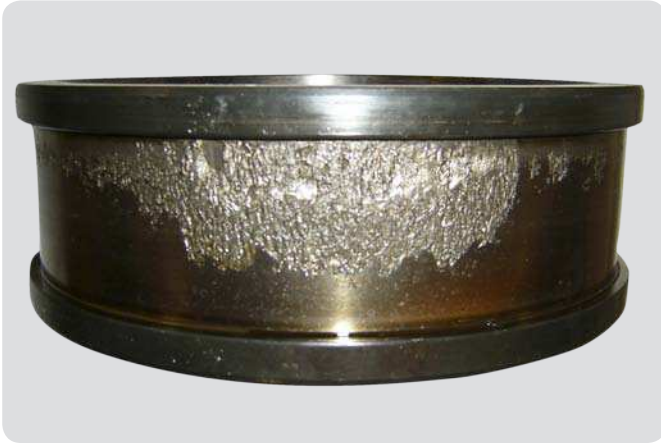
Innenring eines Zylinderrollenlagers Unzureichender Schmierfilm, starke Schiefstellung, fortgeschrittene Schälung
