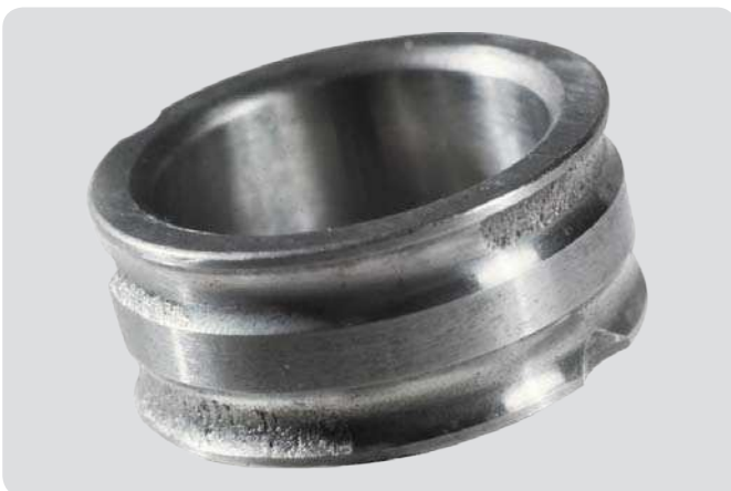
Innenring eines zweireihigen Schrägkugellagers Überlastung und zwei 180° auseinanderliegende Lastzonen infolge übermäßiger Schiefstellung
