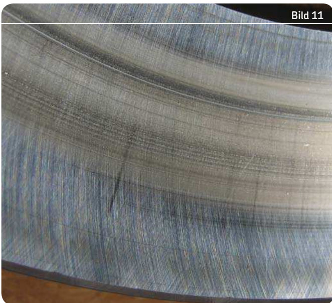
Leichter abrasiver Verschleiß am Außenring eines Pendelrollenlagers
