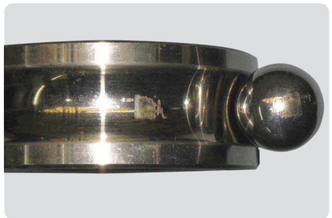
Innenring und Kugel eines Rillenkugellagers Im Zickzackmuster angeordnete stromdurchgangsbedingte Krater an Kugel und Laufbahn
