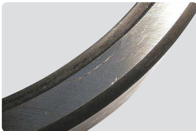
Stirnseite des Außenrings eines Rillenkugellagers Bruch an Dichtungsnut aufgrund von Gewalteinwirkung beim Einbau des Lagers
