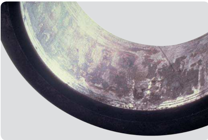
Innenring eines Zylinderrollenlagers Falsche Wellenpassung (zu lose)
