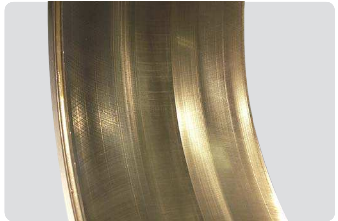
Außenring eines Pendelrollenlagers Abrasier Verschleiß der Laufbahnen – frühes Stadium
