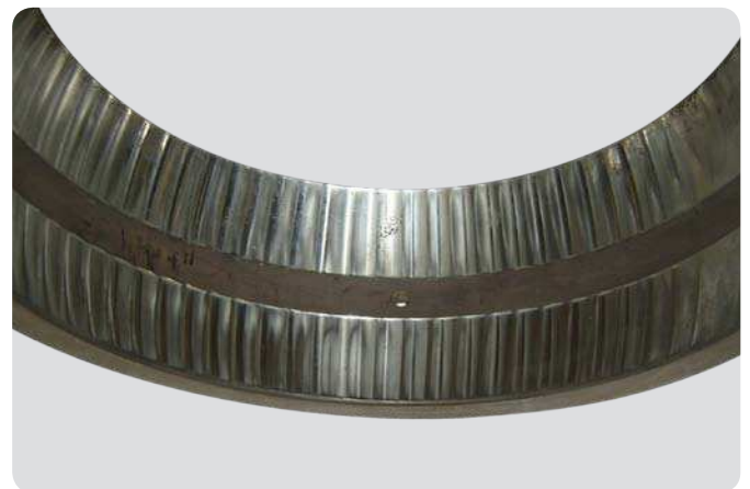
Außenring eines Pendelrollenlagers Einwirkung starker Schwingungen bei Stillstand, Reihen von Stillstandsmarken im Rollenabstand
