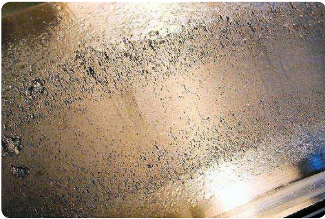
Innenring eines Pendelrollenlagers Unzureichende Schmierung, Oberflächenzerrüttung mit beginnender Schälung
