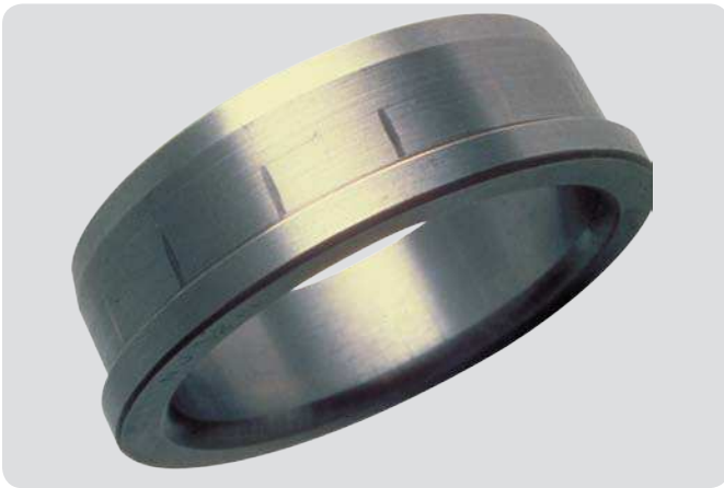
Innenring eines Zylinderrollenlagers Innen- und Außenring wurden bei der Montage nicht richtig ausgerichtet. Axiale Marken im Rollenabstand.
