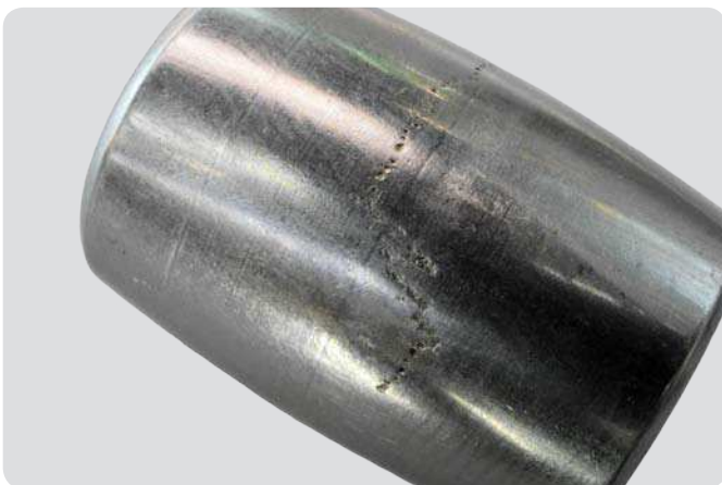
Kugellager – Rolle Große Anzahl stromdurchgangsbedingter Krater in zickzackförmiger Anordnung
