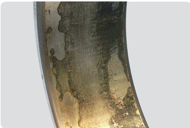
Innenring eines Zylinderrollenlagers Falsche Wellenpassung, ungleichmäßige Unterstützung
