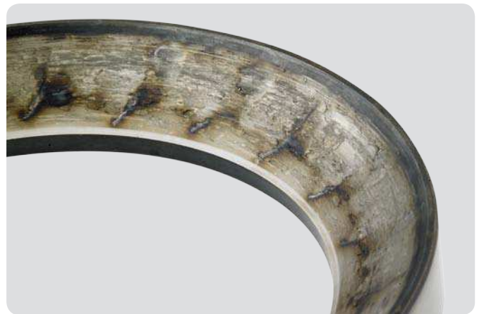
Außenring eines Axial-Pendelrollenlagers Erst adhäsiver Verschleiß, dann übermäßige Wärmeentwicklung und schließlich Fressen
