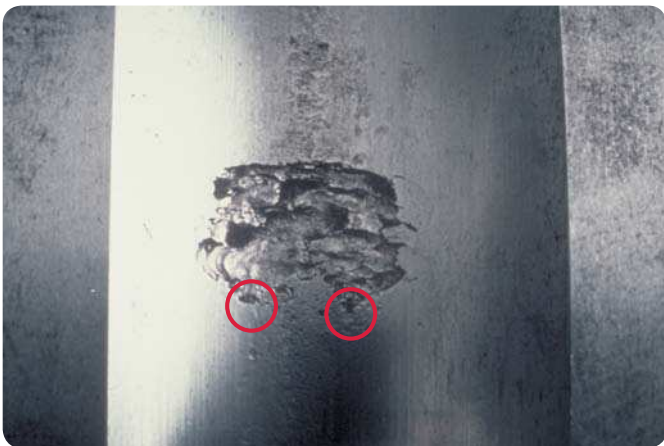
Innenring eines Rillenkugellagers Durch Überrollen von Partikeln verursachte Schälung, beginnend am in Rollrichtung hinteren Ende von Eindrückungen (so genanntes „V-Pitting“)
