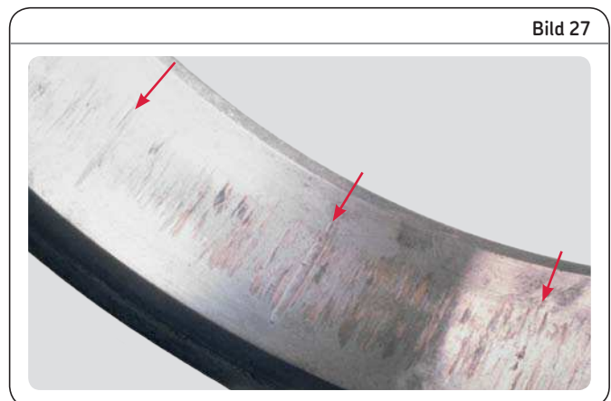
Stillstandsmarken (Rillen) an der Laufbahn des Außenrings eines Zylinderrollenlagers
