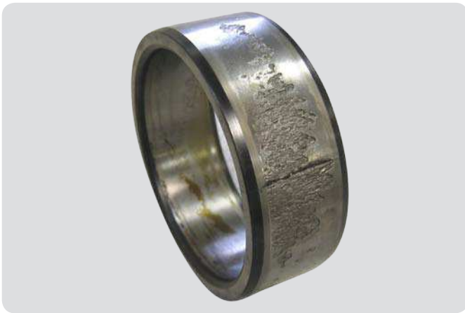
Innenring eines Zylinderrollenlagers Starke Schälung – Ermüdungsbruch als Folgeschaden
