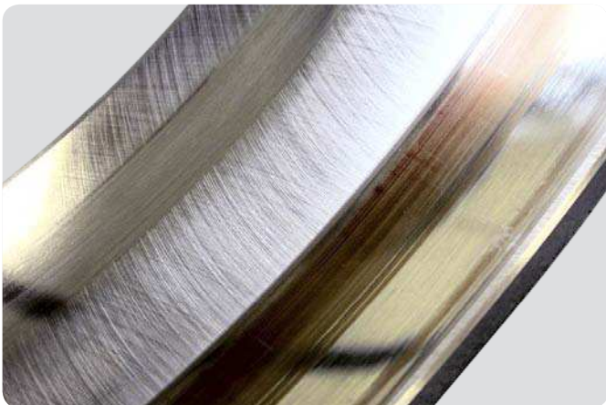
Außenring eines Pendelrollenlagers Abrasier Verschleiß der Laufbahnen. Die axial belastete Fläche ist außerdem teilweise verfärbt, was auf unzureichende Schmierung und Wärmeentwicklung hinweist. Die andere Laufbahn weist eine schmalere, matt glänzende Laufspur auf.
