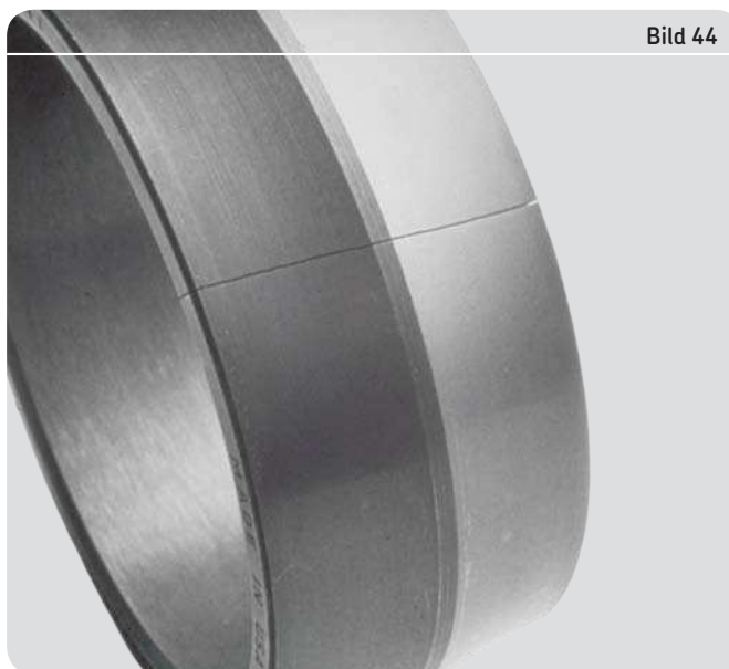
Gebrochener Innenring eines Pendelrollenlagers mit Kegelbohrung infolge eines zu langen Verschiebewegs
