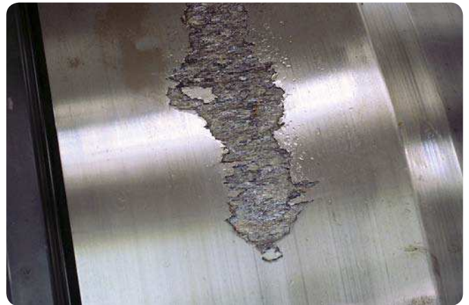
Innenring eines Pendelrollenlagers Materialermüdung
