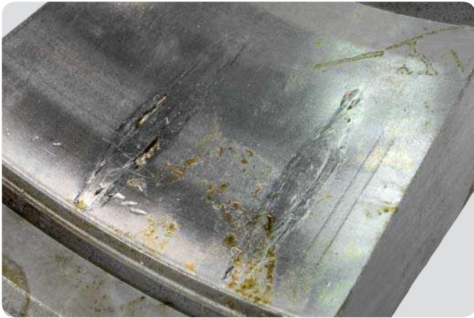
Außenring an einem zweireihigen Kegelrollenlager Verformung und darauf folgende Schälung im Rollenabstand durch Überbeanspruchung und Schiefstellung im Stillstand
