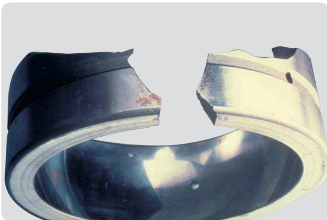
Außenring eines Pendelrollenlagers Gewaltbruch infolge eines falschen Gehäusesitzes (am Boden des Gehäuses eingeschlossene Späne)
