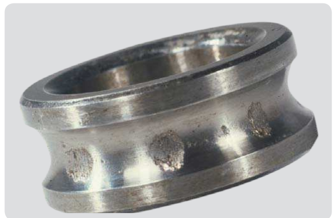
Innenring eines Rillenkugellagers Schälungen im Kugelabstand aufgrund von Stoßbelastung beim Einbau
