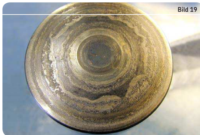
Ansmierungen auf der Kontaktfläche eines Axial-Pendelrollenlagers
