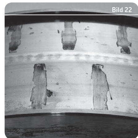
Beginnende Ätzstellen im Wälzkörperabstand an der Laufbahn des Innenrings eines Pendelrollenlagers
