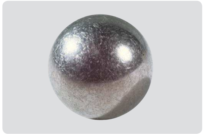
Rillenkugellager – Kugel Durch Partikeleindrückungen geschädigte Kugeloberfläche infolge stark verunreinigten Schmierstoffs
