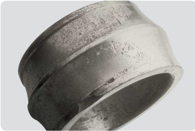
Innenring eines Pendelrollenlagers Abrasiver Verschleiß der Laufbahnen aufgrund von Verunreinigung und daraus resultierender unzureichender Schmierung – eine Laufbahn ist infolge axialer Belastung stärker beschädigt
