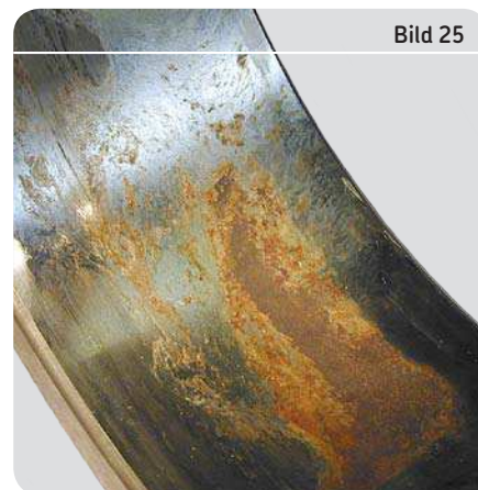
Passungsrost an der Innenringbohrung infolge hoher Belastung oder inadäquaten Wellensitzes
