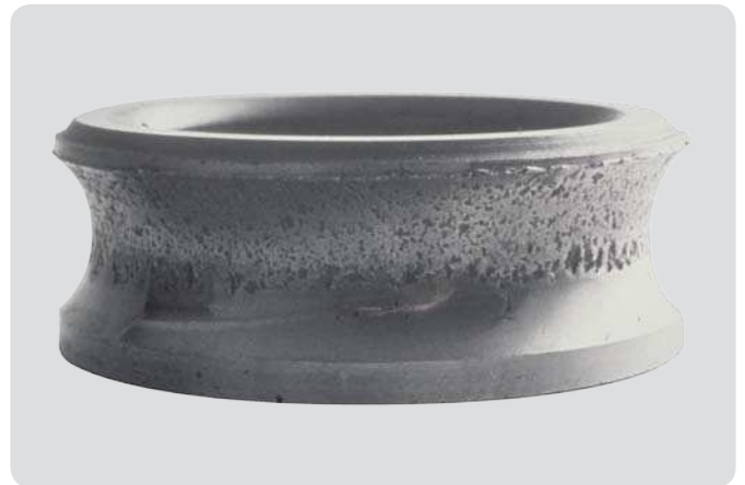
Innenring eines Rillenkugellagers Zu dünner Schmierfilm und Schälung infolge übermäßiger Axialbelastung
