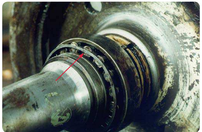
Auf Eisenbahnradsatz montiertes Kegelrollenlager Bleibende Verformung (Abplattung) durch direkten Hieb auf den Käfig bei der Montage
