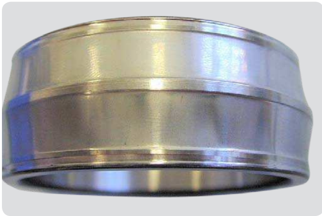
Innenring eines Pendelrollenlagers Abrasier Verschleiß der Laufbahnen aufgrund verunreinigungsbedingter unzureichender Schmierung – leicht glänzend
