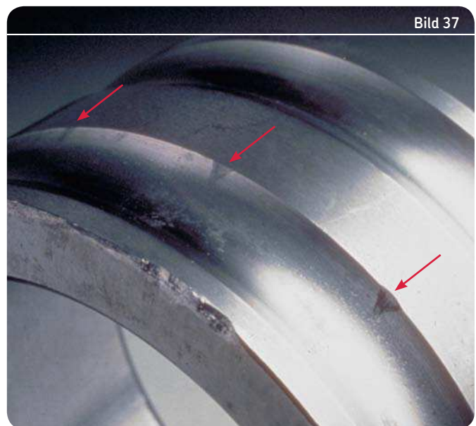
Kugeleindrückungen an der Laufbahn eines zweireihigen Schrägkugellagers aufgrund unsachgemäßer Montage
