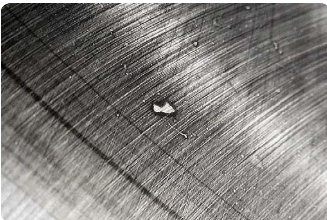
Außenring eines Pendelrollenlagers Überrollung metallischer Partikel, die während der Montage eingedrungen sind – mangelnde Sauberkeit
