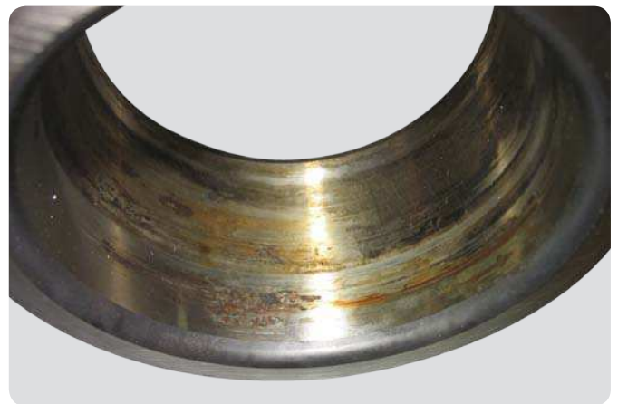
Innenring eines Kegelrollenlagers Falsche Wellenpassung
