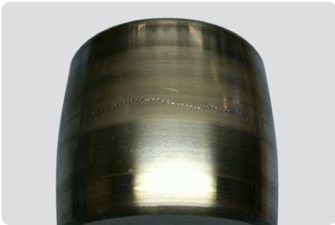
Kugellager – Rolle Große Anzahl stromdurchgangsbedingter Krater in perlenschnurartiger Anordnung
