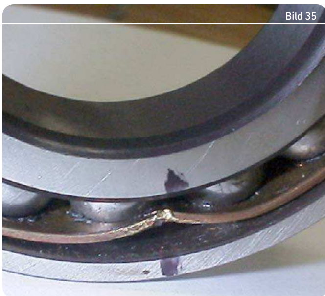
Plastische Verformung am Käfig eines Schrägkugellagers aufgrund unsachgemäßer Handhabung
