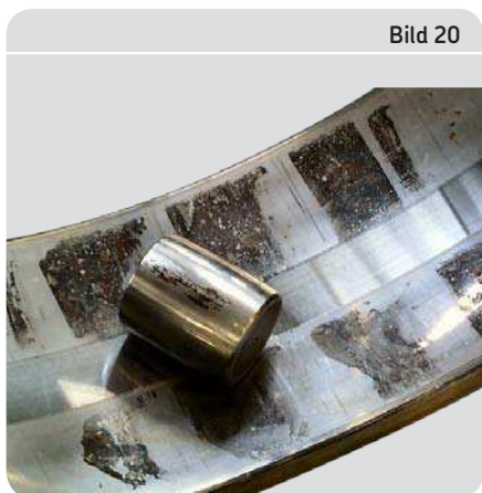
Korrosion an Außenring und Wälzkörper eines Pendelrollenlagers
