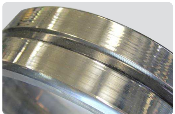
Außenring eines Pendelrollenlagers Wandern des Rings im Gehäuse aufgrund falscher Passung – Anzeichen von abrasivem Verschleiß an Außenfläche
