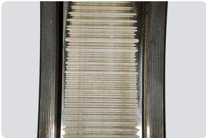
Außenring eines Zylinderrollenlagers Waschbrettmuster in fortgeschrittenem Stadium
