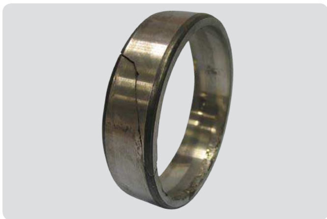
Außenring eines Pendelkugellagers Bruch infolge übermäßiger Schiefstellung und über der Laufbahnkante laufender Kugeln
