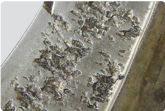
Außenring eines Pendelrollenlagers Oberflächenzerrüttung und fortgeschrittene Schälung infolge von verunreinigungsbedingtem abrasivem Verschleiß
