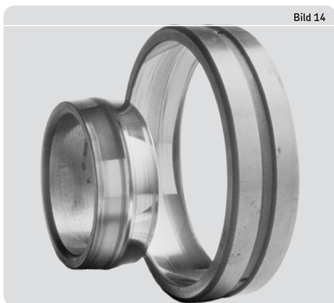
Polierverschleiß (spiegelähnliche Laufbahnoberflächen) an den Innen- und Außenringen eines Pendelrollenlagers
