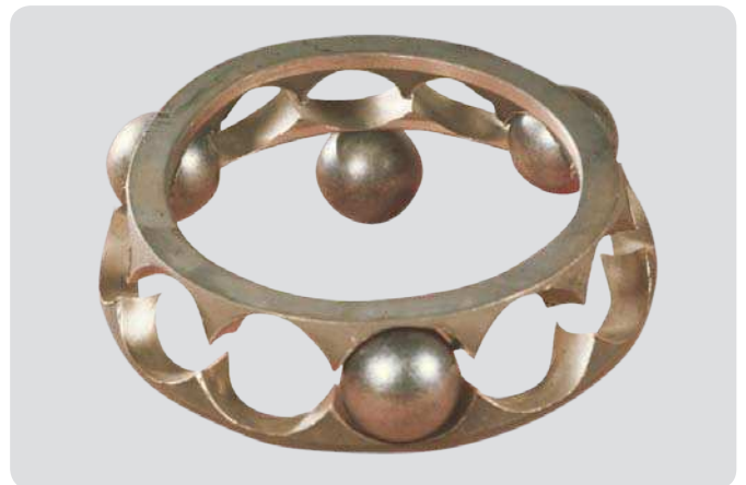
Käfig eines Schrägkugellagers Abrasiver Verschleiß der Käfigtaschen infolge unzureichender Schmierung und Schwingungen. Verschlissene Käfigstege.
