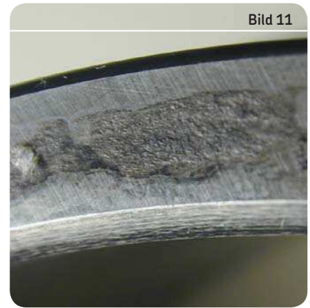
Außenring: Passungsrost an der Stirnseite
