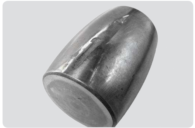
Axial-Kugellager – Rolle Starke Schlageinwirkung, plastische Verformung
