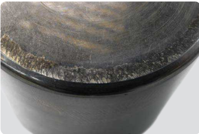
Kegelrollenlager – Rolle Marken von adhäsivem Verschleiß an der breiten Rollenstirnseite infolge von Verunreinigung und unzureichender Schmierung
