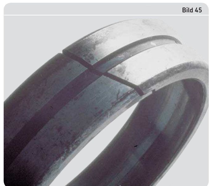
Ermüdungsbruch am Außenring eines Pendelrollenlagers
