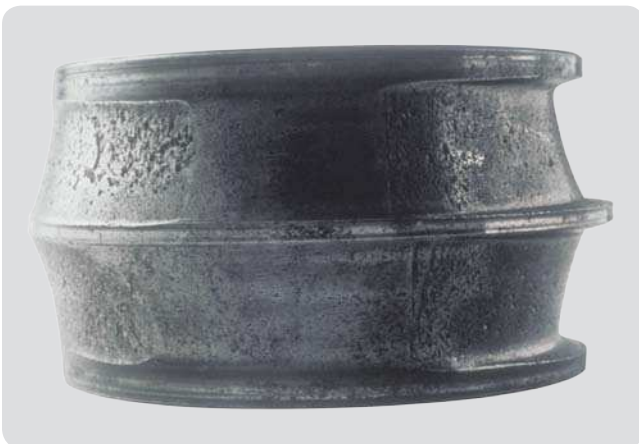
Innenring eines Pendelrollenlagers Starker abrasiver Verschleiß an festem Innenring – zwei Verschleißzonen, eine davon mit starkem Verschleiß; Wandern des Innenrings führte zu zweiter Verschleißzone
