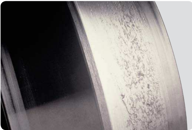
Innenring eines Pendelrollenlagers Zu niedrige Last in Verbindung mit unzureichender Schmierung
