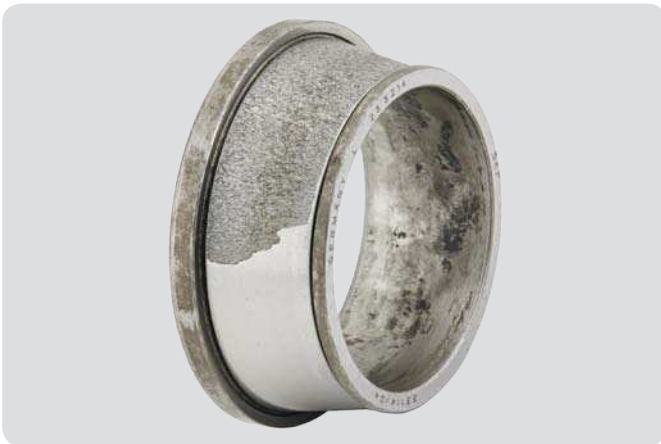
Innenring eines Kegelrollenlagers Unzureichender Schmierfilm, großflächige Schälung
