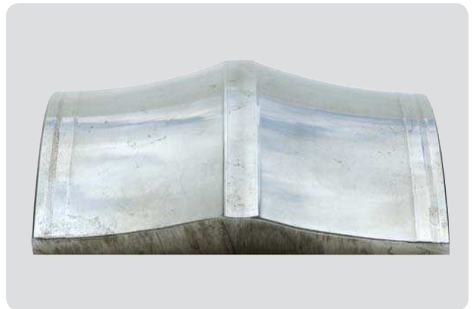
Innenring eines Pendelrollenlagers Abrasier Verschleiß der Laufbahnen infolge von Verunreinigung durch feine Partikel – eher glänzend. Aufgrund von Käfigtaschenverschleiß haben die Käfige auf beiden Seiten eine Rille in den Werkstoff gegraben.
