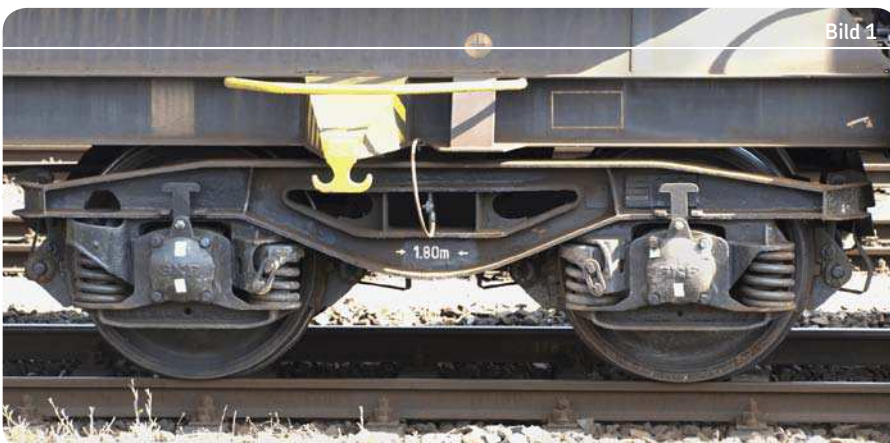
Güterwagons mit „Y-25“-Drehgestell, einschließlich integriertem Radsatzlager mit Doppelfederaufhängung
