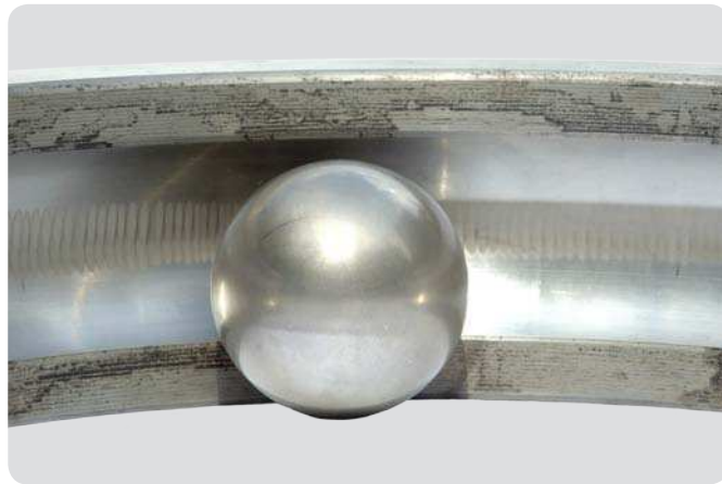
Außenring und Kugel eines Rillenkugellagers Waschbrettmuster an der Außenringlaufbahn und matte Kugeloberfläche
