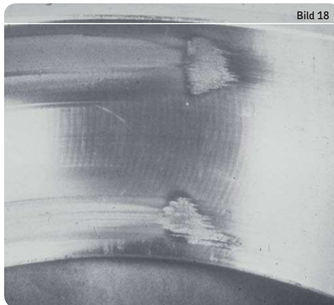
Ansmierungsschaden an den Laufbahnen des Außenrings eines Pendelrollenlagers (Ansmierungen im Bereich des Eintritts in die Lastzone)
