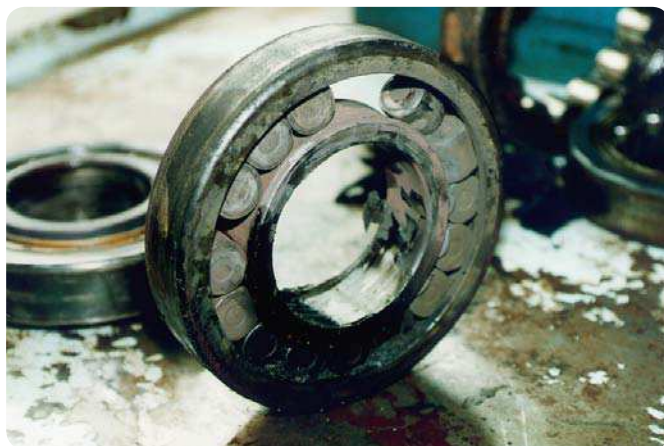
Zylinderrollenlager – Innenring, Außenring und Rollen Festgefressenes Lager – Gewaltbruch am Käfig infolge von Schmierproblemen
