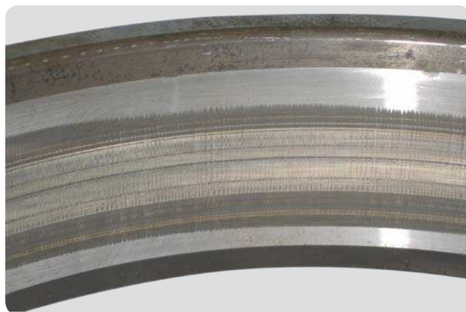
Außenring eines Zylinderrollenlagers Waschbrettmuster im Anfangsstadium
