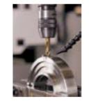
Eine rein synthetische Zusammensetzung zur sicheren Benutzung bei maschinellen Metallbearbeitungsvorgängen mit hoher Drehzahl und Vorschubrate sowie bei der manuellen oder automatischen Einmalbearbeitung.
